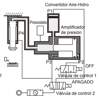
Quando el aire pase por el puerto P4 y P3, el cilindro hidráulico se invertirá rápidamente y, al mismo tiempo, el pistón volverá.
