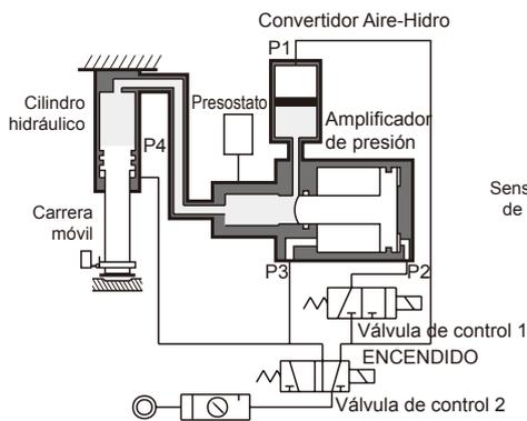
Quando el aire se cargue desde el puerto P1, el aceite en el tanque impulsará el cilindro hidráulico rápidamente. La presión es la misma que la del aire, pero la entrada de aceite es más grande en volumen.
